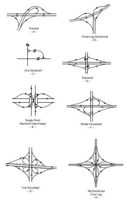
FIGURE 1 AASHTO INTERCHANGE CONFIGURATION TYPES
